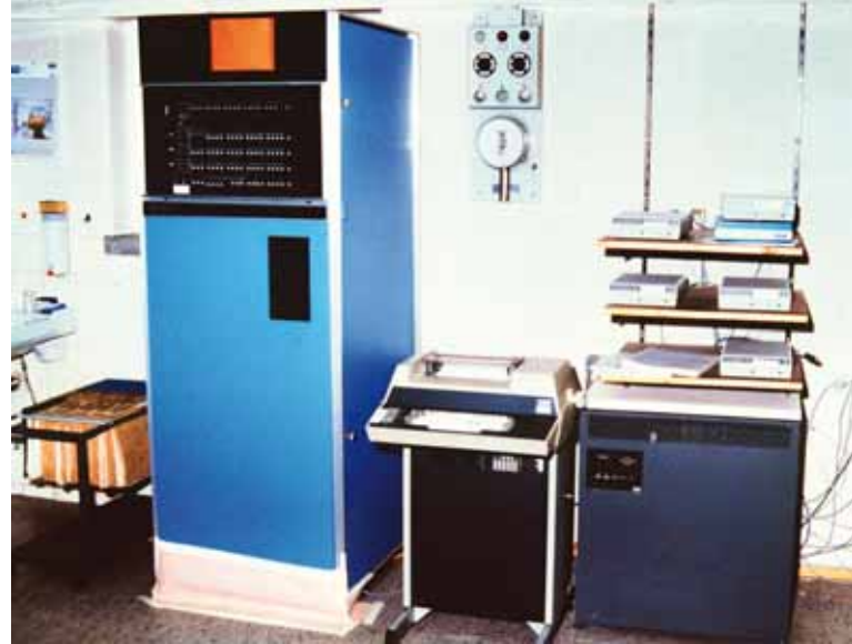
Kommunikationsrechner SEL 3805 lokale Steuereinheit SEL 3283 Modems
