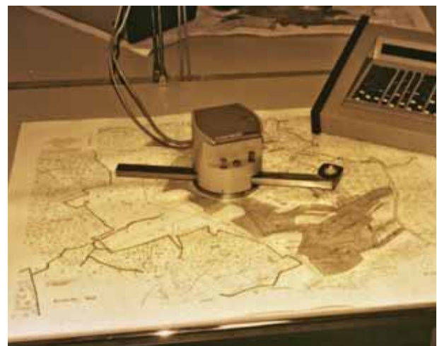
Digitalisiergerät Coradi Digimeter, Polarmesskopf
