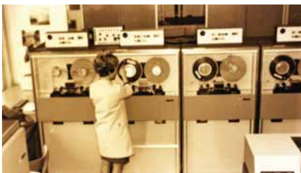
Rechenanlage IBM 360/30 Magnetbandstationen
