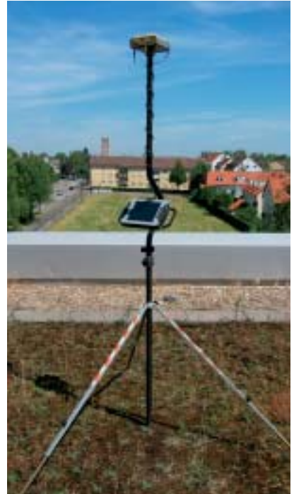
Bild 3: Mobiles GIS mit SAPOS-Rover am Lotstab
