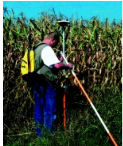
Punktaufnahme mit Hilfe des GPS
