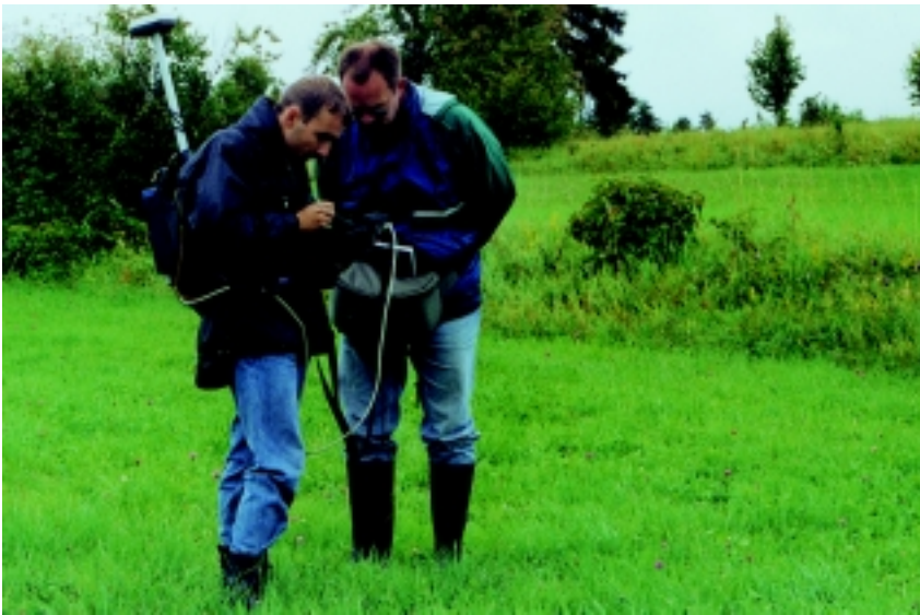
Wertepunktaufnahme mit Hilfe des GPS (Global-Position-Systems)
